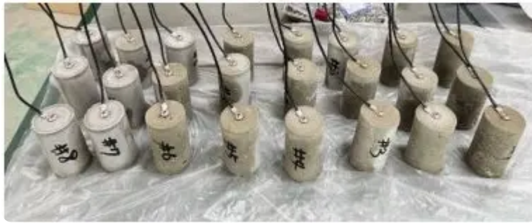
Hình ảnh các mẫu vữa đối chứng (Control) được sử dụng trong thử nghiệm.
